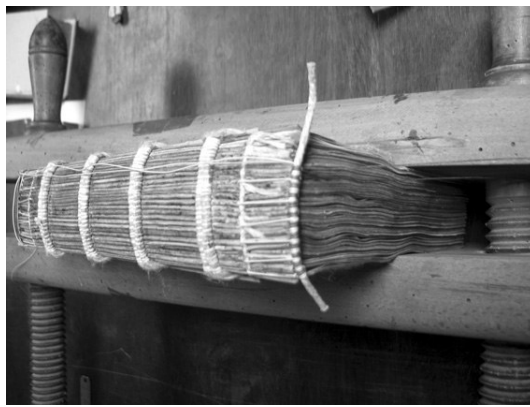
Réalisation de nouvelles tranchefiles à l'ancienne.
