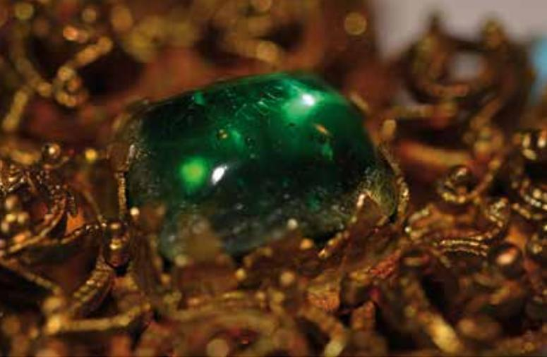
Figure 6. Le cabochon de verre n° 1. Les bulles sont bien visibles dans la masse.
