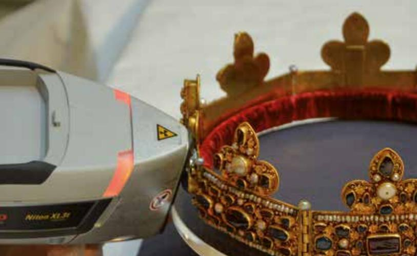
Fig. 2 : XRF portable en train d'analyser une pierre de la couronne.
